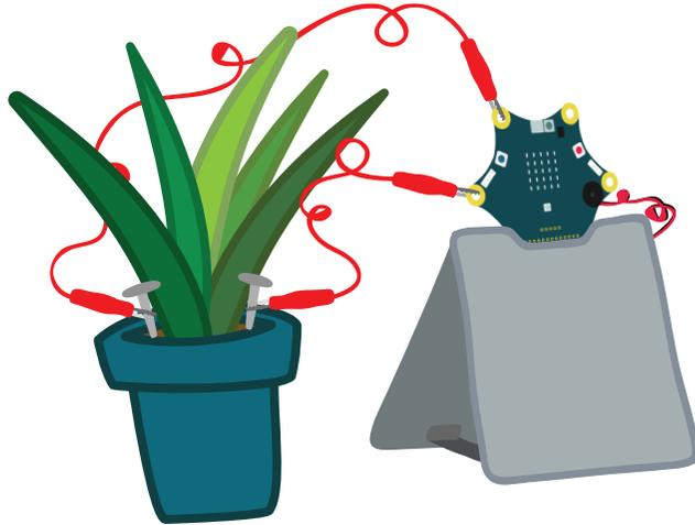
Stecke zwei Nägel oder Schrauben aus Metall in die Erde des Pflanzentopfes. Sie sollen dabei ein gutes Stück voneinander entfernt sein. Nun verbindest du eine Krokodilklemme mit Pin 0 und eine mit Pin- auf deinem Calliope. Die Enden klemmst du jeweils an einen der Nägel oder Schrauben. Starte dein Programm aus Teil 1, mit dem du die Leitfähigkeit von Materialien überprüft hast. Was passiert? Ändert sich das Ergebnis, wenn du die Nägel oder Schrauben an anderen Stellen in die Erde steckst?
