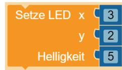
Jede LED wird durch einen x-Wert und einen y-Wert angesprochen. Mit  $x = 3$  und  $y = 2$  wird die LED in der 3. Spalte/2. Zeile angesprochen.
